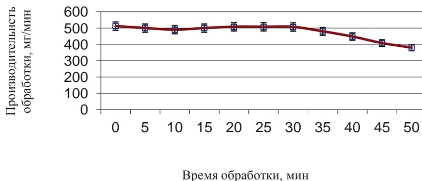
Рис. 5. Изменение производительности обработки диффузионно – борированным порошком во время магнитно – абразивной обработки
