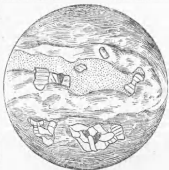
Рис. 2. Кристаллические агрегаты бёмита в каолините и ленточном неравномерно окисленном хлорите. \times 10
