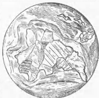
Рис. 3. Бёмит внутри хлоритовой ленты. \times 260
