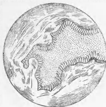
Рис. 1. Тонкоагрегатный и лепестково-чешуйчатый каолинит в хлорите. \times 70
