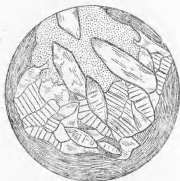
Рис. 4. Кристаллы и зерна бёмита с каолинитом из жеоды внутри стяжения магнетита. \times 300
