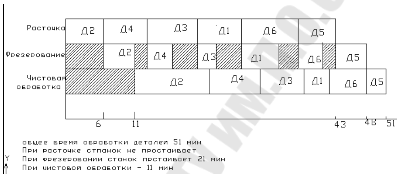
Рисунок 8.1 Оптимальный график Ганта для обработки деталей на трех станках
