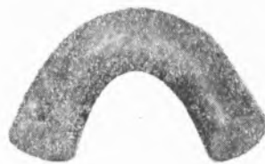
Рис. 2. Образец марганца, изогнутый при 1100°
