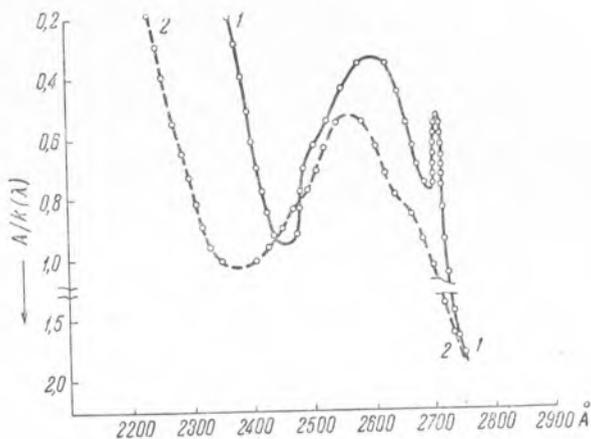
Рис. 1. 1—тимонуклеиновая кислота 0,0029 M + L-триптофан 0,0029 M до применения давления; 2 — то же после применения давления. A — константа прибора, k — коэффициент экстинкции
