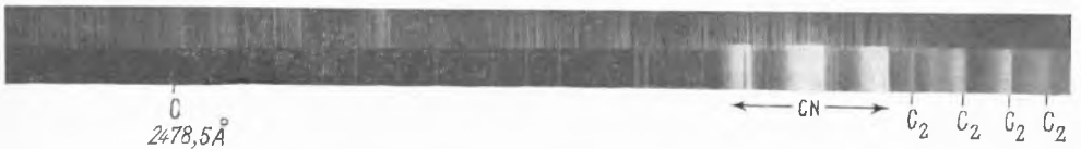
Рис. 4. Спектр факельного разряда в смеси окиси углерода и азота
