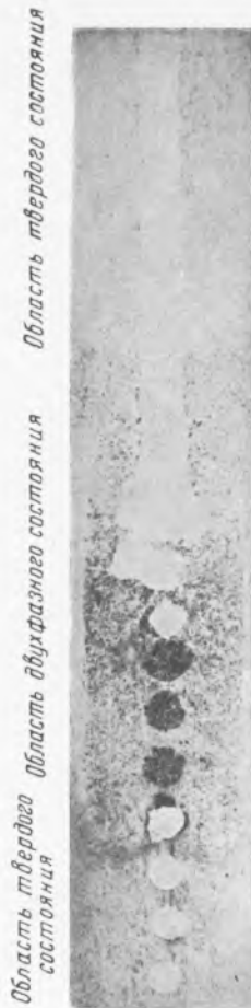
Рис. 2. Продольное осевое сечение пробы стали с 1% углерода. Диаметр 40 мм, длина 200 мм. Температура на середине высоты 1370°, выдержка 5 час. а—серный отпечаток, б—шлиф
