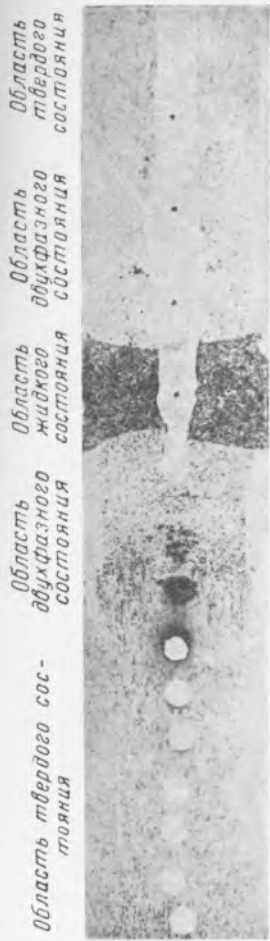
Рис. 1. Серный отпечаток с продольного осевого сечения пробы стали с 1% углерода. Диаметр пробы 40 мм, длина 200 мм. Выдержка 5 час.
