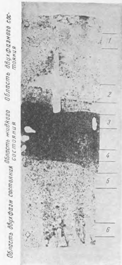
Рис. 3. Серный отпечаток с продольного осевого сечения пробы стали с 1% углерода. Диаметр 63 мм, высота 185 мм
