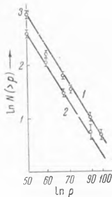
Рис. 4. Интегральный спектр толчков в камере в двойном логарифмическом масштабе. 1 — спектры толчков в незащищенной камере, 2 — в камере под слоем графита 128 г/см 2
