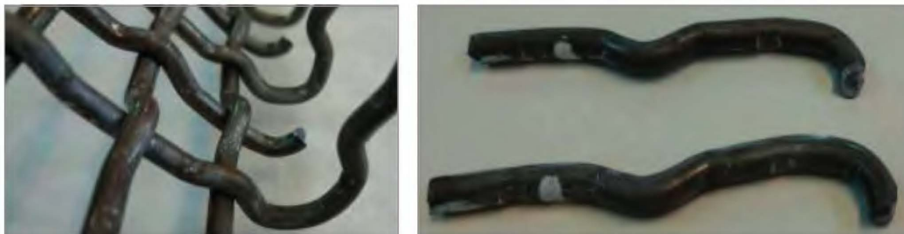
Рис. 2. Внешний вид фрагментов сетки и проволоки с изломами
