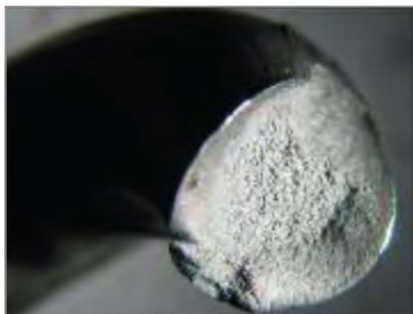
Рис. 3. Внешний вид проволоки в зоне излома. \times 4
