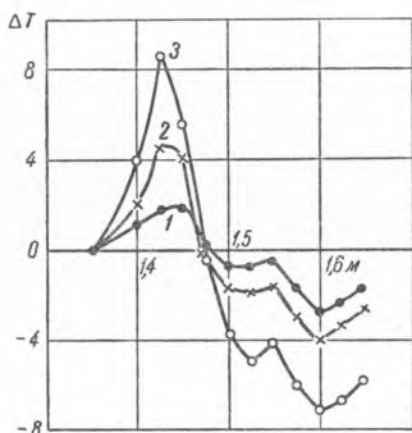
Рис. 3. Дифференциальный спектр поглощения поливинилового спирта ( T_r - T_{20^\circ} ). 1 — 70^\circ , 2 — 100^\circ 3 — 150^\circ
