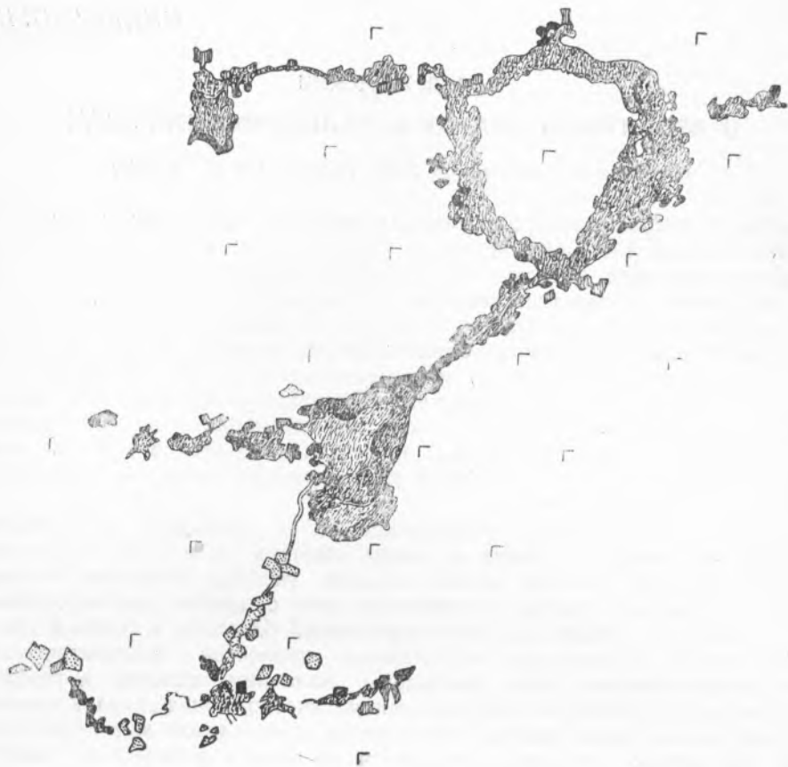
Рис. 1. Эпигенетическое образование кварца (черное), карбонатов (точки) и ангидрита (вертикальная штриховка) в галитовой породе (Г) по микротрещинкам близ соляной глины (серое). Ново-Карфагенское месторождение, с глубины 207,5 м. Зарисовка В. Н. Кругленковой. Нат. вел.
