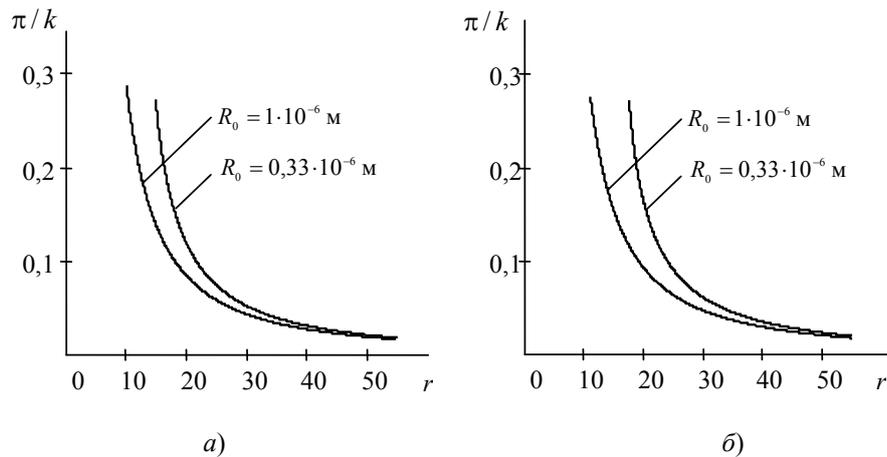
Рис. 3. Корреляция «параметр затухания по времени – параметр пространственной неоднородности возмущения»:
