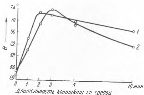
Рис. 2. Влияние длительности контакта с воздухом и водой на краевой угол смачивания галенита: 1 — контакт с воздухом, 2 — контакт с водой, содержащей растворенный кислород
