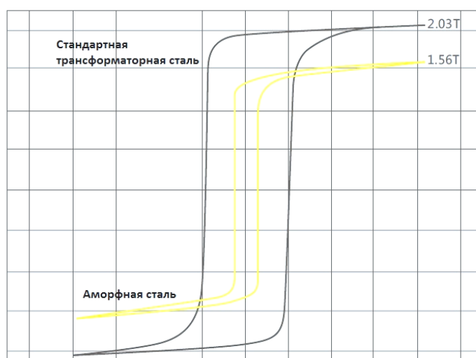
Рис. 1. Сравнительные потери на гистерезис аморфной и электротехнической стали
