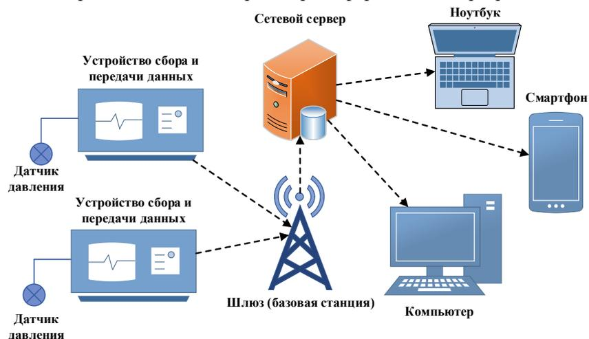
Рис. 1. Схема взаимодействия устройств в сети LoRaWAN Fig. 1. Connection diagram of devices in the LoRaWAN network
