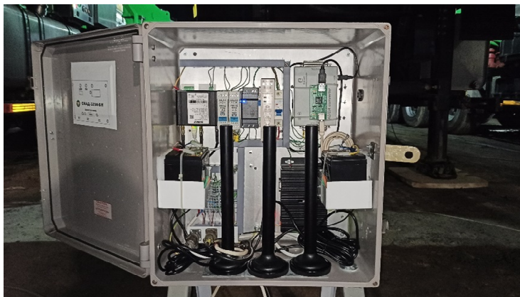
Рис. 1. Устройство сбора первичных данных, установленное на скважине № 466 Речицкого нефтяного месторождения
