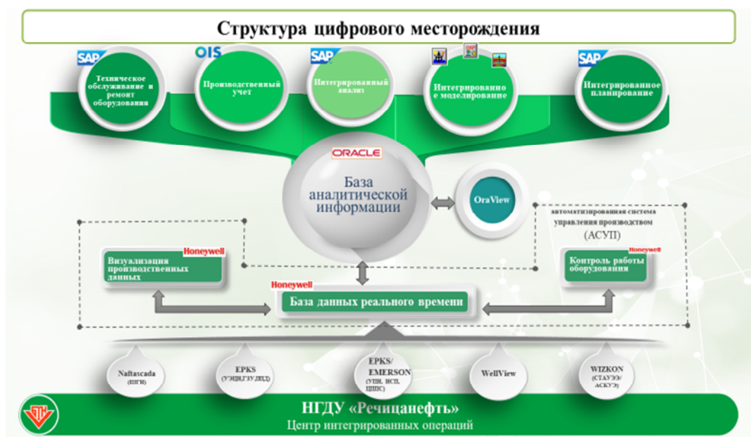
Рис. 1. Структура программного обеспечения «Цифровое месторождение»
