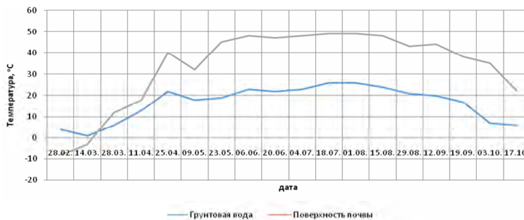
Рис. 1. Графики изменения температуры грунтовых вод и поверхности почвы в течение года
