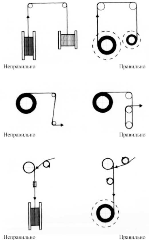
Рис. 2. Схемы заправки проволоки в узле намотки на приемную катушку
