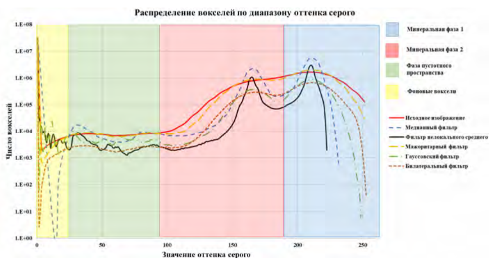
Рис. 2. График распределения вокселей по градациям значений оттенка серого цвета для исходного изображения и изображений после применения фильтров
