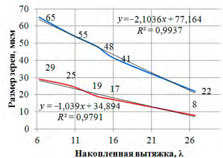
Рис. 3. График влияния накопленной степени деформации на размер зерна проката: — макс; — мин
