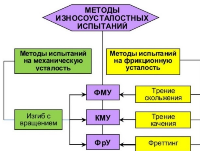
Рис. 1. Алгоритм создания нового класса испытательного оборудования: КМУ – контактно-механическая усталость; ФМУ – фрикционно-механическая усталость; ФрУ – фреттинг-усталость
