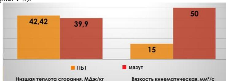
Рис. 1. Нижшая теплота сгорания (МДж/кг) и вязкость кинематическая (мм<sup>2</sup>/с) для мазута и печного бытового топлива
