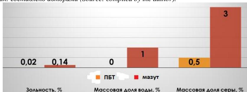
Рис. 3. Зольность, массовая доля воды и массовая доля серы (%) для мазута и печного бытового топлива
