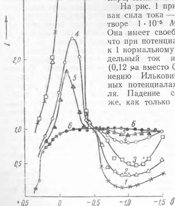
Рис. 2. Поляризационные кривые, полученные в растворе 1 \cdot 10^{-4} M K_2S_2O_8 в присутствии сернокислого натрия разной концентрации: 1 — 1 \cdot 10^{-3} N Na_2SO_4 ; 2 — 3 \cdot 10^{-3} N ; 3 — 1 \cdot 10^{-2} N ; 4 — 5 \cdot 10^{-2} N ; 5 — 0,1 N ; 6 — 1,0 N
