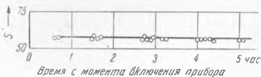
Рис. 2. Режим работы спектрофотометра при эталонном источнике света
