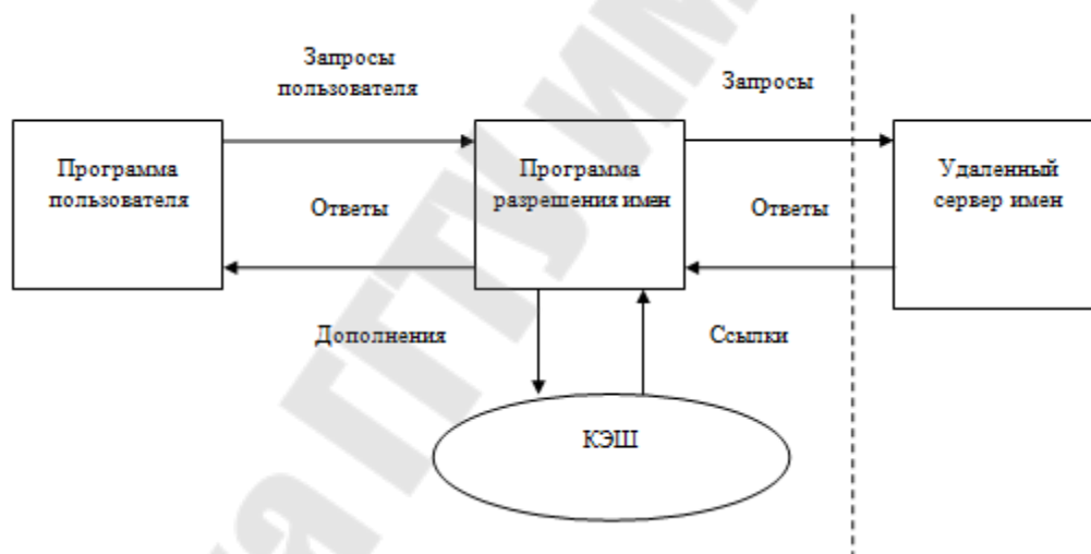
Рисунок 53 – Принцип работы с серверами имен
