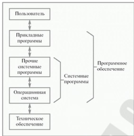
Рис. 1.1. Слои программного обеспечения компьютерной системы
