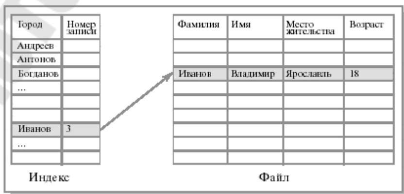
Рис. 11.2. Пример организации индекса для последовательного файла
