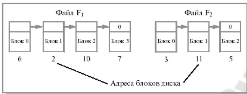
Рис. 1. Хранение файла в виде связанного списка дисковых блоков
