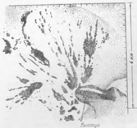
Рис. 2. Затвердевшие брызги расплавленного металла на поверхности индивидуального экземпляра (№ 1500) Сихотэ-Алинского метеоритного дождя. (Рисунок автора по наблюдениям под биноклем)
