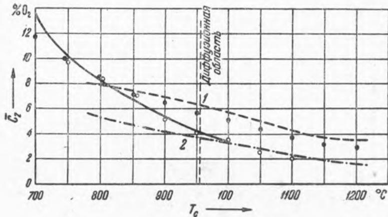
Рис. 2. Изменение концентрации кислорода в газах, выходящих из углеродного канала ( $l=250$  мм и  $d \sim 5$  мм). Дутье воздушное, 5 л в минуту. 1 — теоретическая кривая для неизотермического режима; 2 — теоретическая кривая для изотермического режима.
