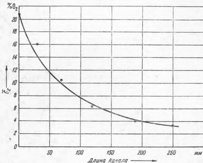
Рис. 1. Изменение концентрации кислорода по длине канала. Опыты А. О. Цухановой<sup>(4)</sup>. Углеродный канал  $d \approx 5$  мм;  $T = 1000^{\circ}\text{C}$ ;  $w = 20$  м/сек.; 5 л воздуха в минуту
