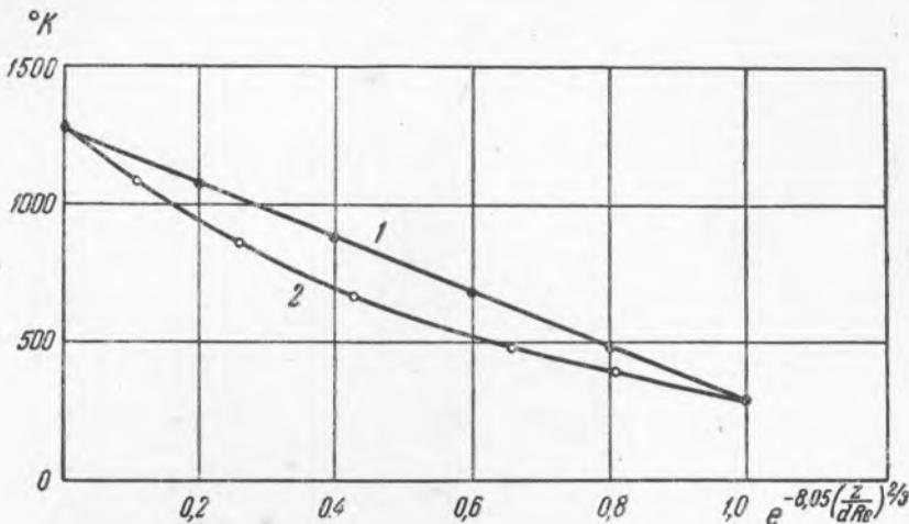
Рис. 3. Влияние неизотермичности режима на теплообмен в канале.
