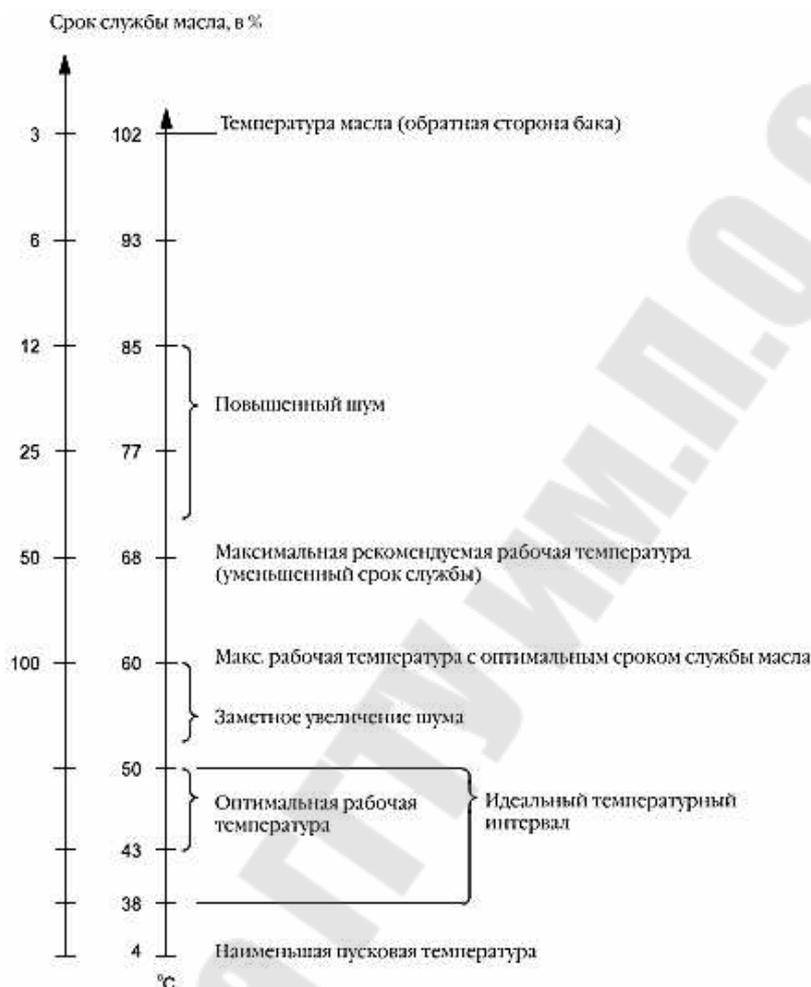
Рис. 3.11. Температурные условия для масел в гидросистемах
