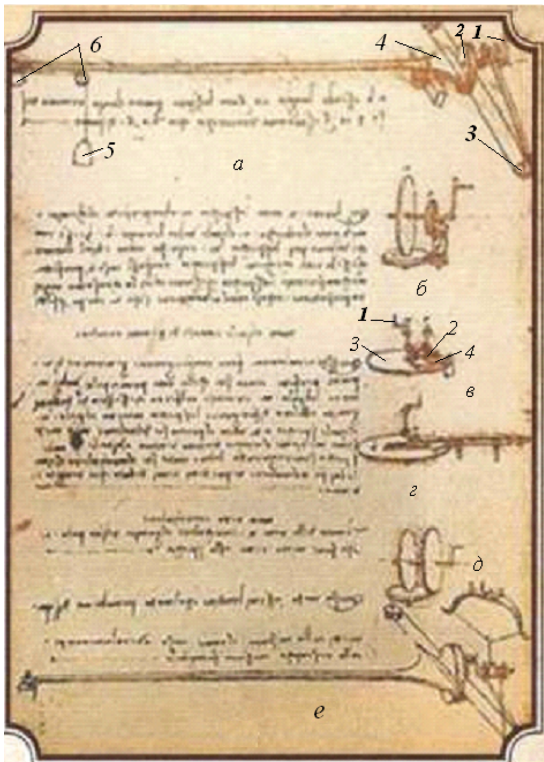
Рис. 3.58. Рисунки станков для обработки линз и зеркал Леонардо да Винчи: a, e – для шлифования зеркал качательными движениями: 1 – рукоятка; 2 – диск; 3 – шкивы; 4 – абразивный сегмент; 5 – груз; 6 – веревки и блоки; б, д – для шлифования периферией абразивного диска; в, г – для шлифования торцом абразивного диска: 1 – рукоятка; 2 – цевочная передача; 3 – поворотный стол; 4 – абразивный диск
