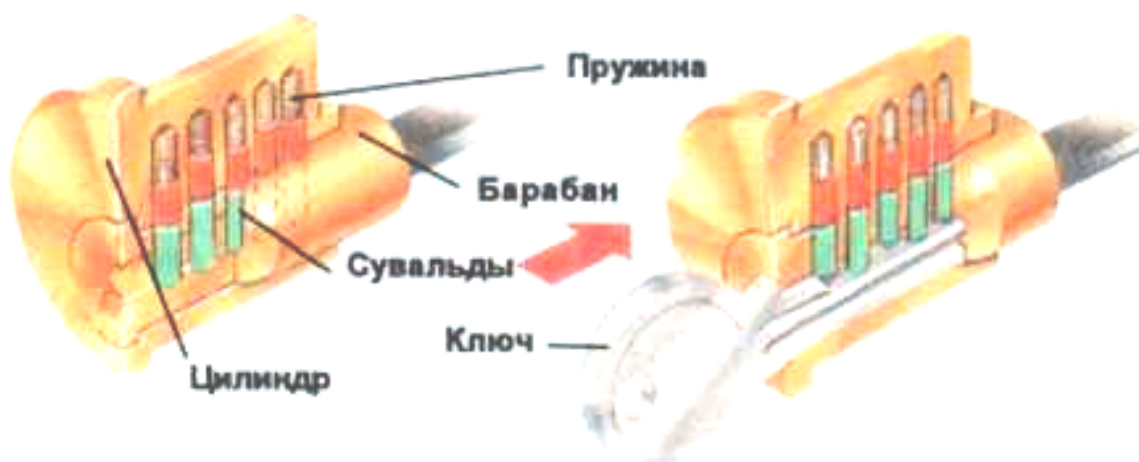
Рис. 5.19. Схема английского замка (конструктор Л. Йейл)
