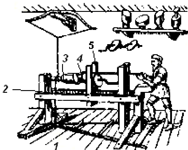
Рис. 3.43. Токарно-овальверный станок (Жак Бессон, 1569 г.): 1 – педаль; 2 – станина; 3 – заготовка; 4 – резец; 5 – поворотный диск
