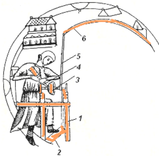
Рис. 3.38. Эскиз обработки на токарном станке: 1 – станина; 2 – педаль; 3 – заготовка; 4 – резец; 5 – веревка; 6 – очеп
