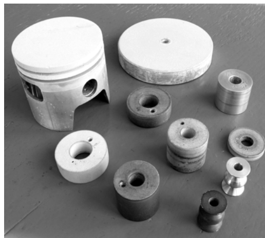
Рисунок 3. – Образцы с покрытием и заготовки для нанесения покрытий
