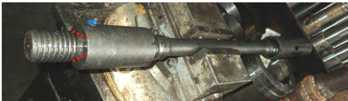
Рисунок 7. – Направление сломов хвостовиков шарнирного торсиона шпинделя ВЗД (показано штриховой красной линией на общем фото неразрушенного шарнира)
