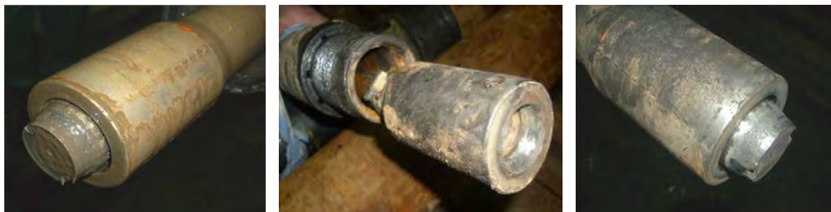
Рисунок 5. – Виды фактического слома хвостовика шарнирного торсиона ВЗД ДРЗ-106.7/8 № 161/690
