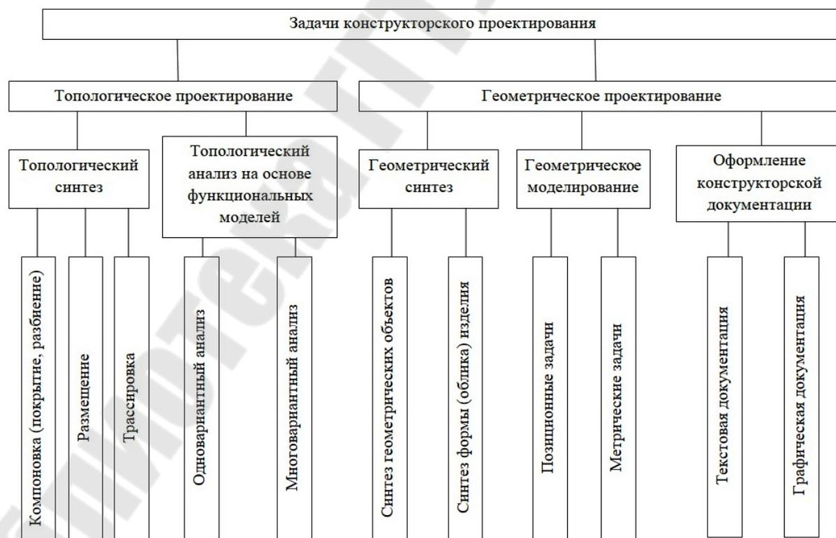
Рис. 2.1. Классификация задач конструкторского проектирования
