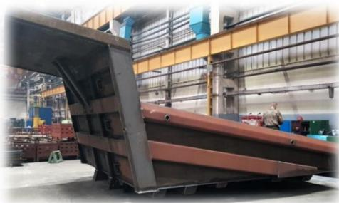
Рис 1. Металлоконструкция кузовов самосвалов на ОАО «БЕЛАЗ»
