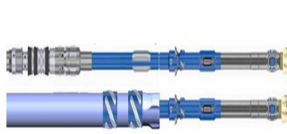
الشكل 2 - تقنية الحفر المباشر TD
