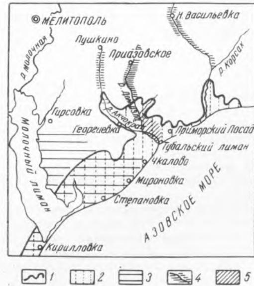
Рис. 1. Схематическая карта распространения газовых залежей в западном Приазовье. 1 — контур газоносности сарматских отложений (газовая залежь заливообразной формы); 2 — контур газоносности сарматских отложений; 3 — контур газоносности меловых отложений; 4 — шнурковая газовая залежь в киммерийских осадках; 5 — газоносная площадь местного промышленного значения
