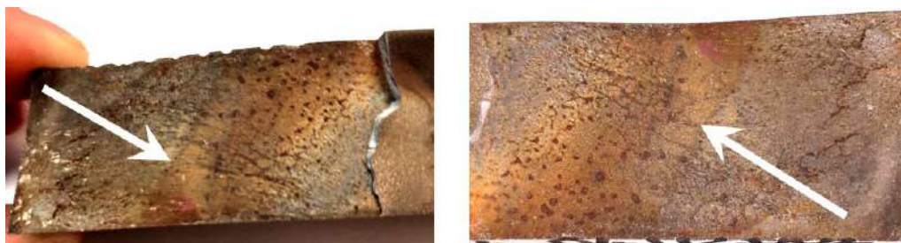
Рис. 4 – Поверхность разрушения фрагмента детали «Полуматрица»
