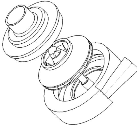
Рисунок 1 – Твердотельная 3-D модель центробежного насоса
