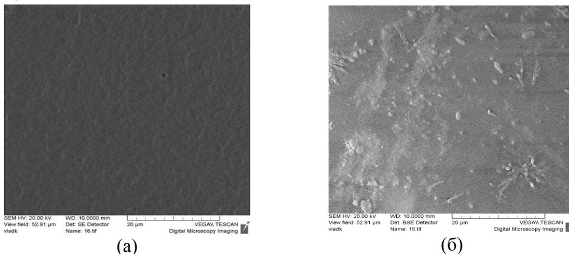
Рисунок 1 - РЭМ-изображения поверхности ксерогелей, сформированных на основе водной дисперсии аэросила А-300 содержащего нитрат меди концентрацией 0,3 ммоль/30 мл золя и 0,5 ммоль /30мл золя при указанном увеличении (микрофотографии (а) и (б), соответственно). Все ксерогели прошли восстановительную обработку в среде водорода при  $T=800\text{ }^{\circ}\text{C}$  в течение 1 ч.
