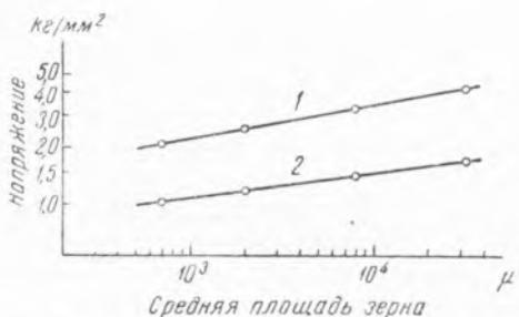
Рис. 2. Нихром 60/20. 1 —  $700^\circ$ , 2 —  $800^\circ$
