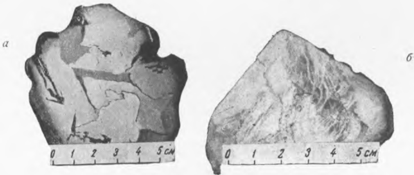
Рис. 4. Протравленные поверхности распиленных пополам образцов: а — целый индивидуальный экземпляр, видна внутренняя балочная структура и крупные включения троилита (слева, справа и внизу на фото); б — распиленный пополам осколок. Видна внутренняя, сильно деформированная структура
