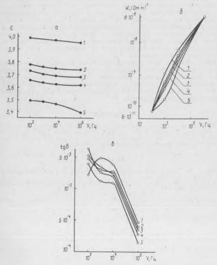
$\mathsf{Ч}\mathsf{a}\mathsf{c}\mathsf{r}\mathsf{o}\mathsf{t}\mathsf{h}\mathsf{a}\mathsf{s}$  зависимость диэлектрической проницаемости (a), удельной электрической проводимости (б) и тангенса угла диэлектрических потерь (в) кварцевых гель-стекол для различных концентраций церия: 1, 2, 3, 4, 5 — Ce=5; 3; 1; 0,25; 0; % соответственно; T=293 K
