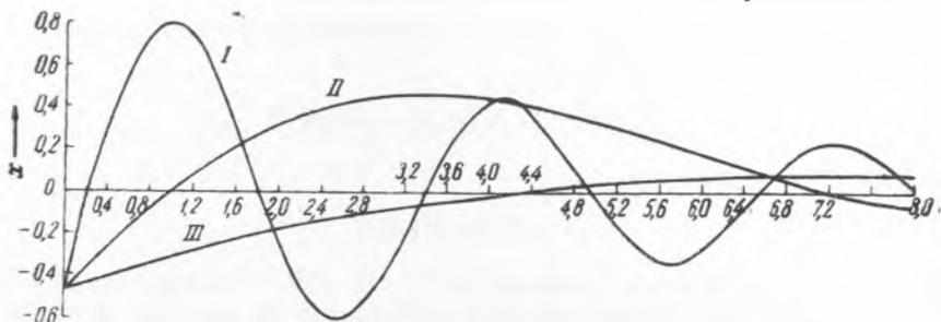
Рис. 1. Графики переходной функции для частного случая системы второго порядка при одинаковых декрементах, но при разных периодах:
