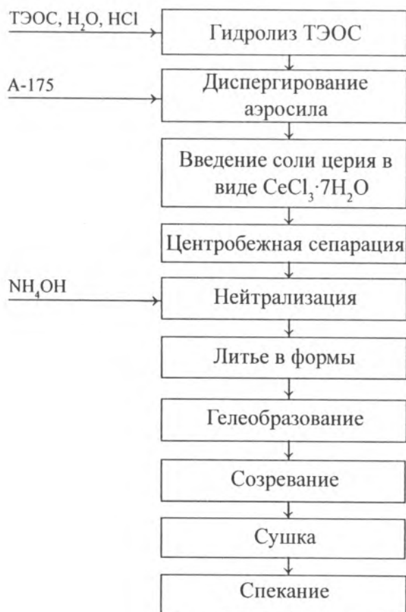
Рис.1 Технологическая схема получения гелевого кварцевого стекла, легированного церием.
