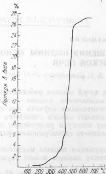
Рис. 1. Кривая потери в весе в зависимости от температуры продукта разрушения подины
