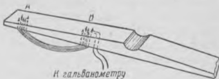
Фиг. 2. Прикрепление спаев термопары к деревянной пластинке.
