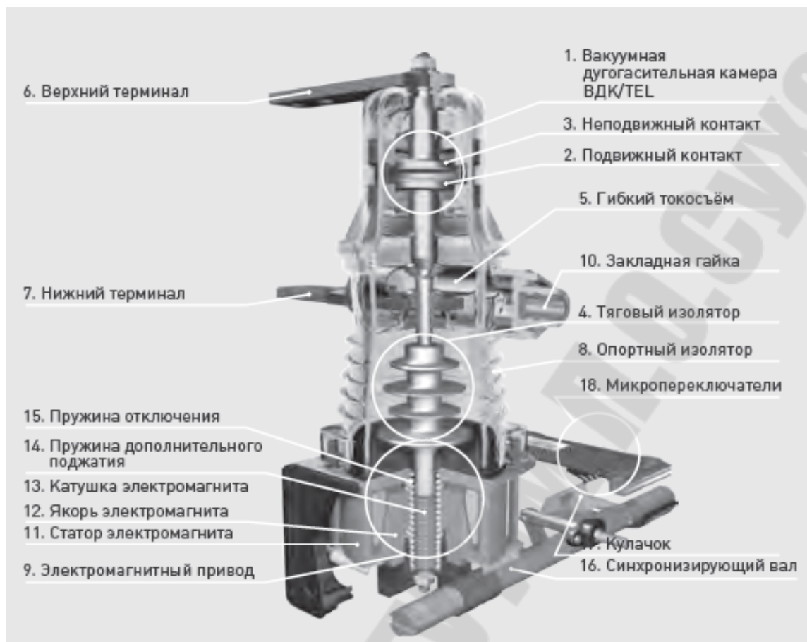
Рис. 4.2. Конструкция полюса коммутационного модуля выключателя BB/TEL-10
