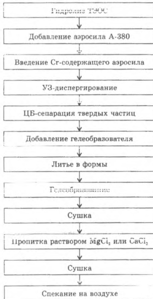
Рис. 4. Схема синтеза нанокомпозитов с использованием золь-гель метода
