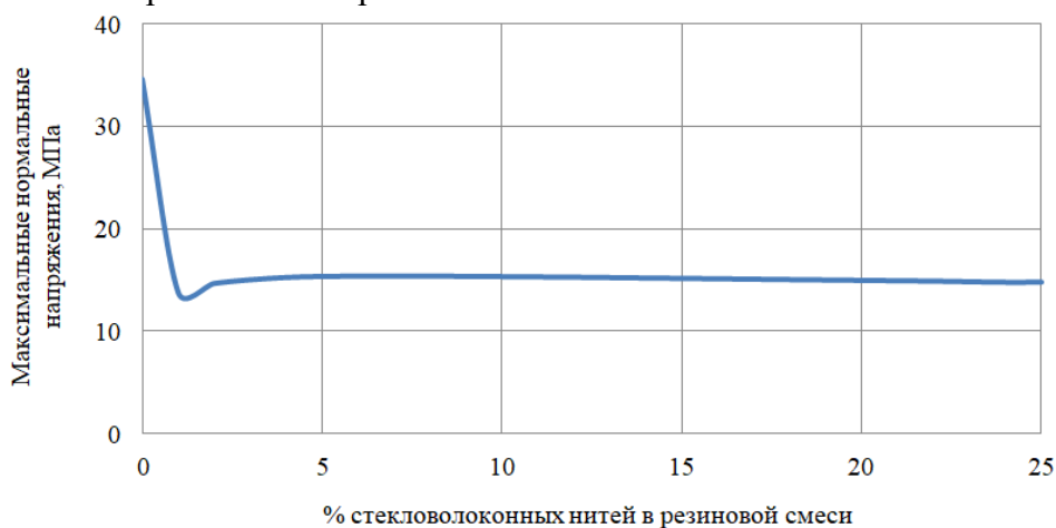
Рисунок 2 – Результаты расчета нормальных напряжений в прокладке
