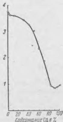
Фиг. 2. Коррозия сплавов Zn+Cd в  $\frac{1}{1}N$  растворе  $\text{H}_2\text{SO}_4$ .
