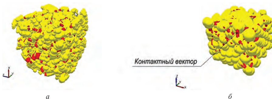
Рис. 4. Фрагменты моделей стержневой смеси в уплотненном состоянии зерен песка фракции 02: a – с применением угловатых зерен песка; b – с применением округлых зерен песка
