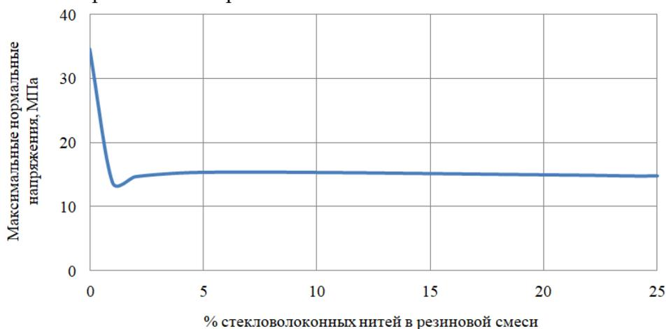
Рисунок 2 – Результаты расчета нормальных напряжений в прокладке
