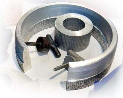
Рис. 1. Внешний вид аддитивных наплавов из Al-сплавов
